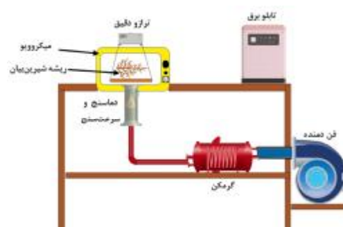
شکل ۲- شماتیک دستگاه خشک کن
