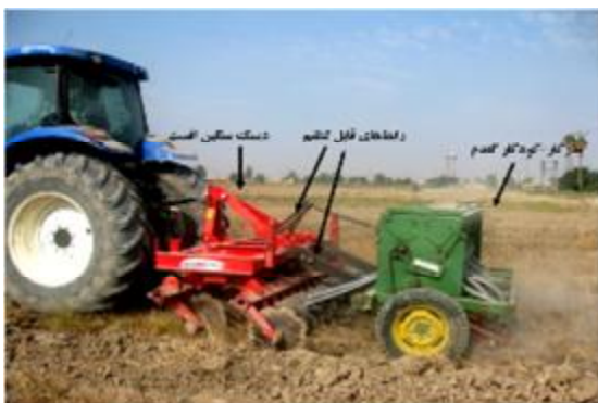
شکل ۱- خطی کار غلات منضم شده به دیسک سنگین در حال کار در زمین دست نخورده پوشیده از بقایا
