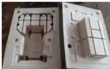
(ت) قالب ماسه‌ای یکبار مصرف ایجاد شده با دو مدل و یک ماهیچه
