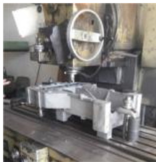
ب) فرآیند ماشینکاری (کف تراشی، سوراخ کاری و رزوه زنی)
