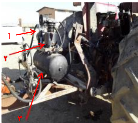
شکل ۵- اتصال موتور هیدرولیک به پمپ هوا و مخزن فشار، تجهیزات شامل (۱) پمپ هوا، (۲) موتور هیدرولیکی و (۳) مخزن
