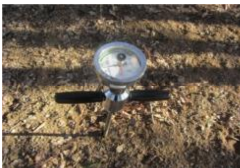
شکل ۷- نفوذسنج عمودی مدل Hand penetrometer Eijkelkamp
