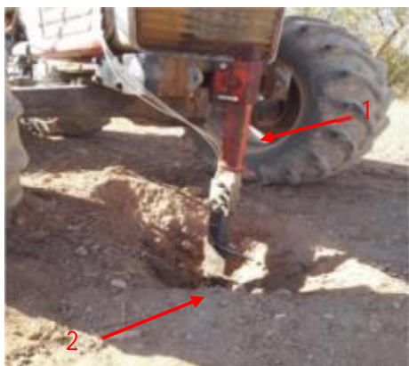
شکل ۴- نمایی از حسگر نیوماتیکی پس از نصب بر روی تراکتور و آماده آزمون شامل (۱) شاسی و ساقه حسگر، (۲) نازل‌ها
