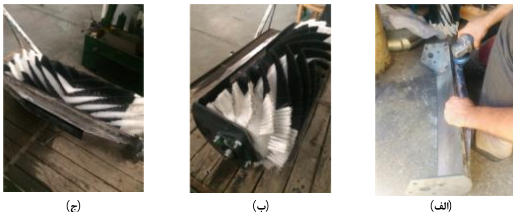
شکل ۳- دماغه و برس جمع‌آوری محصول: (الف) شاسی دماغه جمع‌آوری؛ (ب) برس و یاتاقان‌های سوار شده بر روی دماغه؛ و (ج) دماغه جمع‌آوری با دریچه خروجی
