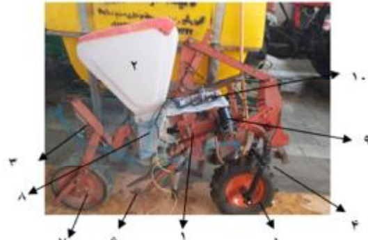
شکل ۱- نمایی کلی از قسمت‌های اصلی سامانه کارنده، ۱- شاسی، ۲- مخزن بذر، ۳- اهرم تثبیت عمق، ۴- شیار بازکن، ۵- چرخ حمل، ۶- پوشاننده، ۷- فشاردهنده، ۸- موزع، ۹- الکتروموتور DC، ۱۰- مدار فرمان
