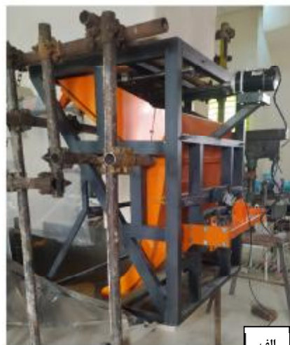
شکل ۳- الف) نمای واقعی دستگاه و ب) طراحی سه بعدی دبی‌سنج مبتنی بر نیروی مرکزگرا در نرم‌افزار SolidWorks
