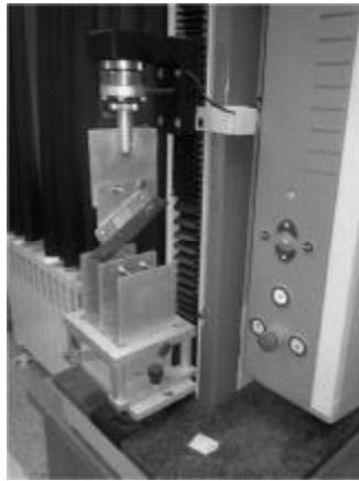
شکل ۱- نحوه قرار گیری تیغه برش در زاویه ۴۵ درجه
