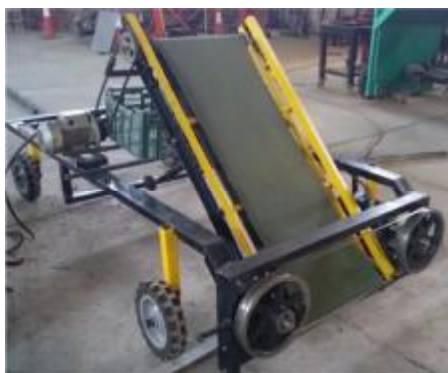
شکل ۷- نمای سامانه انتقال، کوپلینگ و تنظیم ارتفاع برش در ماشین برداشت سبزیجات برگی
