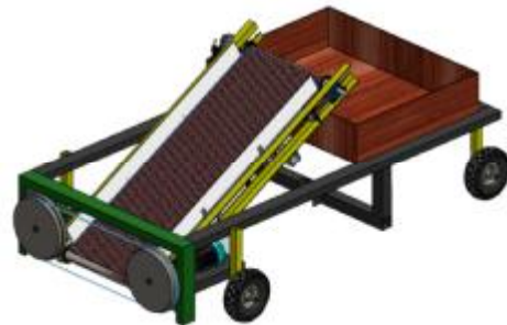
شکل ۱- طرح اولیه کل دستگاه و سامانه برش در ماشین برداشت سبزیجات برگی
