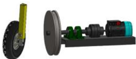
شکل ۶- سامانه کوپلینگ و تنظیم ارتفاع برش
