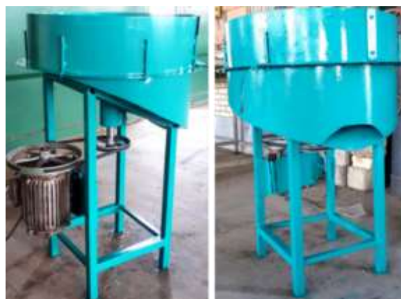
شکل ۲- تصاویر پوست‌گیر ضربه‌ای یولاف طراحی و ساخته شده از دو نمای مختلف
