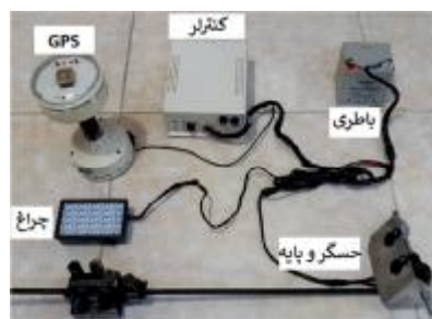
شکل ۷ - سامانه پایش فراصوت و اجزای تشکیل دهنده آن
