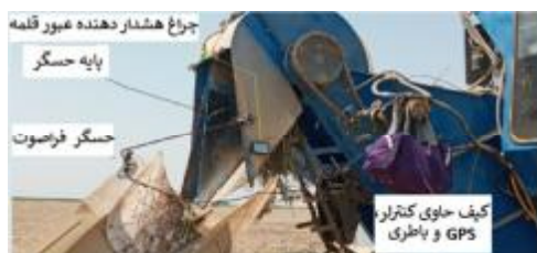
شکل ۸ - موقعیت نصب سامانه ساخته شده بر روی کارنده
