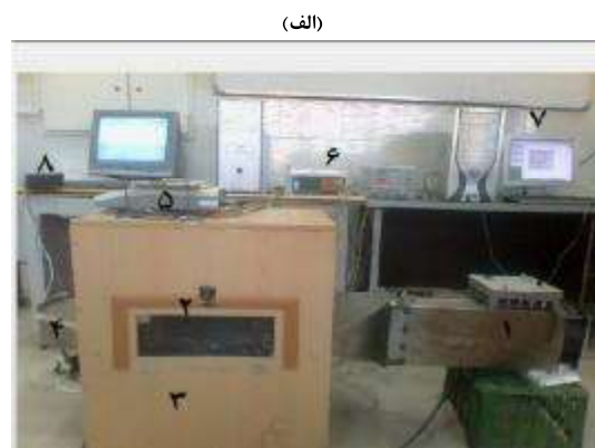
شکل ۱- خشک‌کن مادون قرمز الف: ۱- دمنده ۲- درب خشک‌کن ۳- بدنه خشک‌کن ۴- دریچه خروجی هوا ۵- ترازو ۶- ثبات ۷- رایانه ۸- دیمر؛ ب: شکل و نمای خشک‌کن
