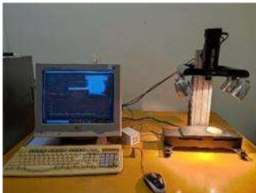
شکل ۱- سامانه تصویربرداری فراطیفی برای تشخیص سطوح مختلف تقلب در پودر فلفل قرمز.
