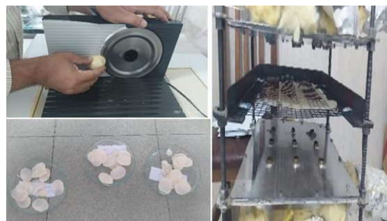
شکل ۳. مراحل برش، آماده سازی و خشک کردن نمونه‌ها
