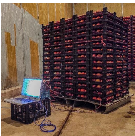
شکل ۲- آرایش حسگرها در هر پالت. الف: نحوه نام‌گذاری، ب: تصویر واقعی از پالت اول.
