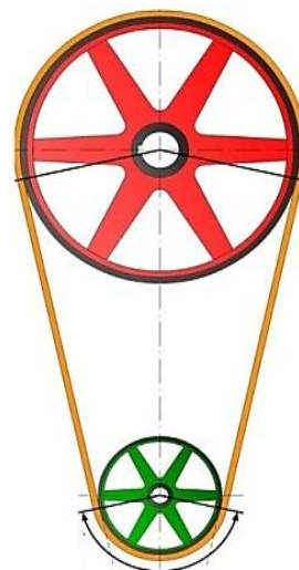
شکل ۷- سازوکار تسمه و پولی
