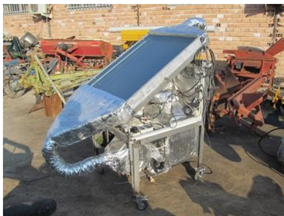
شکل ۱- نما و تصویر حقیقی نمونه ساخته شده خشک‌کن پمپ حرارتی مورد استفاده در آزمایش
