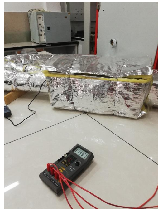
شکل ۱- محفظه جاذب و بخشی از تجهیزات نصب شده
