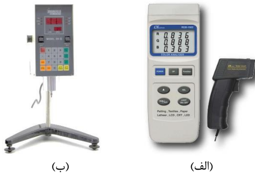
شکل ۳- دستگاه‌های آزمایشگاهی استفاده شده به منظور اندازه‌گیری: الف) خواص نوری نمونه کتیرا (Lutron RGB-1002) و ب) گرانروی نمونه ژل شده کتیرا (Brookfield DV-II) (Imanmehr & Heidarisoltanabadi, 2024).
