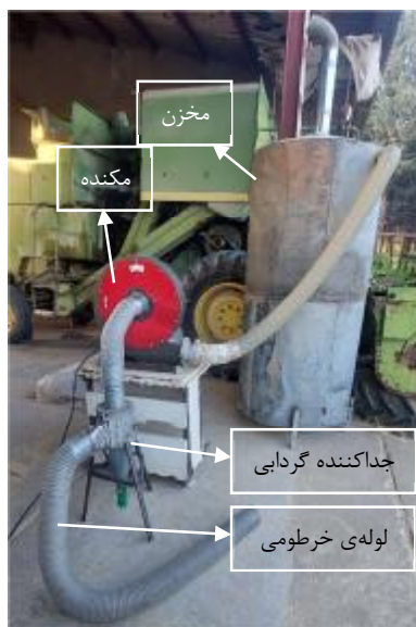
شکل ۳- سامانه جداکننده گردابی مورد استفاده در پژوهش
