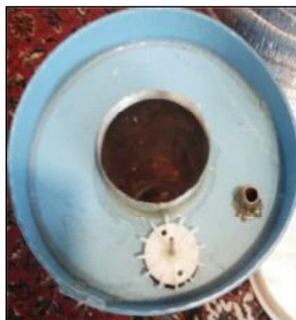
شکل ۳- همزن بستری تعبیه شده در طبقات رآکتور
