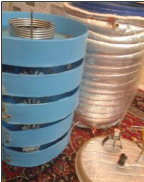
شکل ۲- بدنه رآکتور عایق کاری شده و بسترهای ۵ طبقه
