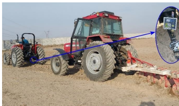
شکل ۱ - روش دو تراکتوری مورد استفاده برای اندازه‌گیری نیروی کششی تراکتور بار و لودسل نصب شده بر روی مجموعه
