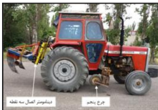
شکل ۵- تراکتور MF-285، مجهز به سامانه ابزار اندازه‌گیری دقیق
