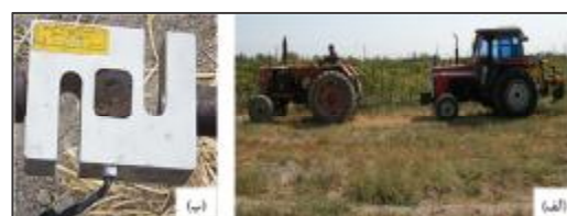
شکل ۶- (الف) اندازه‌گیری مقاومت غلتشی تراکتور (ب) نیروسنج سه تکی مورد استفاده بین دو تراکتور
