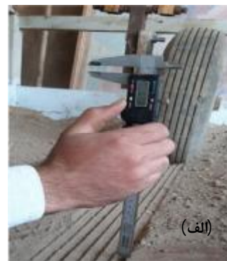
شکل ۱- (الف) محل قرارگیری سلول نیرویی افقی برای اندازه‌گیری مقاومت غلتشی، (ب) اندازه‌گیری میزان فرورفتگی چرخ در خاک و (ج) نتایج آزمون نفوذسنجی خاک انباره
