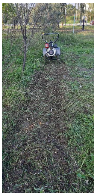
شکل ۸- الف) پوشش گیاهی در باغ مورد آزمون، ب) دستگاه در حال عملیات سله‌شکنی و حذف علف‌های هرز و پ) خاک بعد از عملیات
