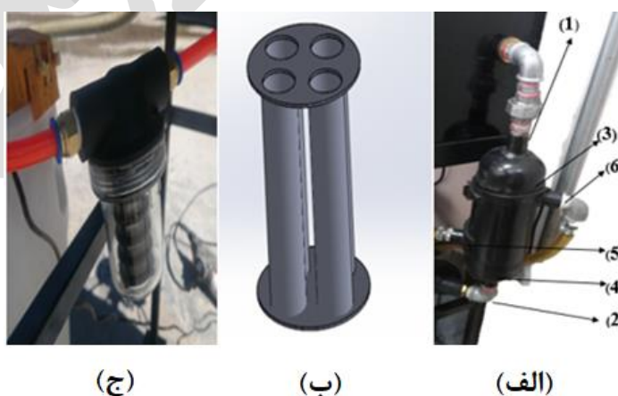
شکل ۲- (الف) نمای کلی چگالنده: (۱) ورودی بخار، (۲) خروج بخار مایع شده، (۳ و ۴) محل اتصال صفحات داخلی، (۵) ورود آب سرد، (۶) خروج آب سرد، (ب) نمای داخلی چگالنده، (ج) محفظه جمع‌کننده مایع خروجی از چگالنده
